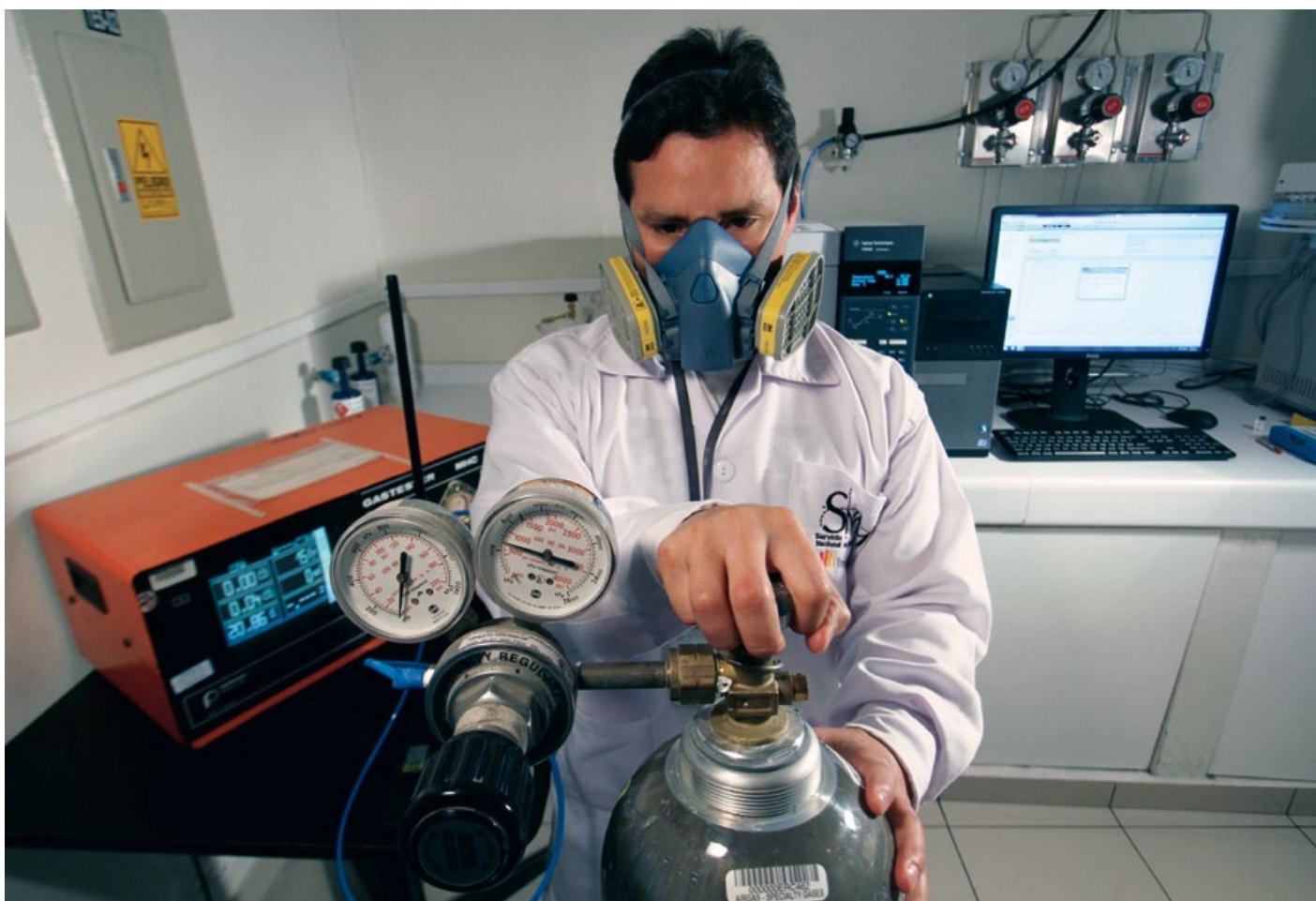
Steve Acco, del Servicio Nacional de Metrología de INDECOPI, interviene en la evaluación de instrumentos de medición de emisiones, utilizando gases de referencia para asegurar que los datos obtenidos sean confiables. Foto: Walter Hupiu
